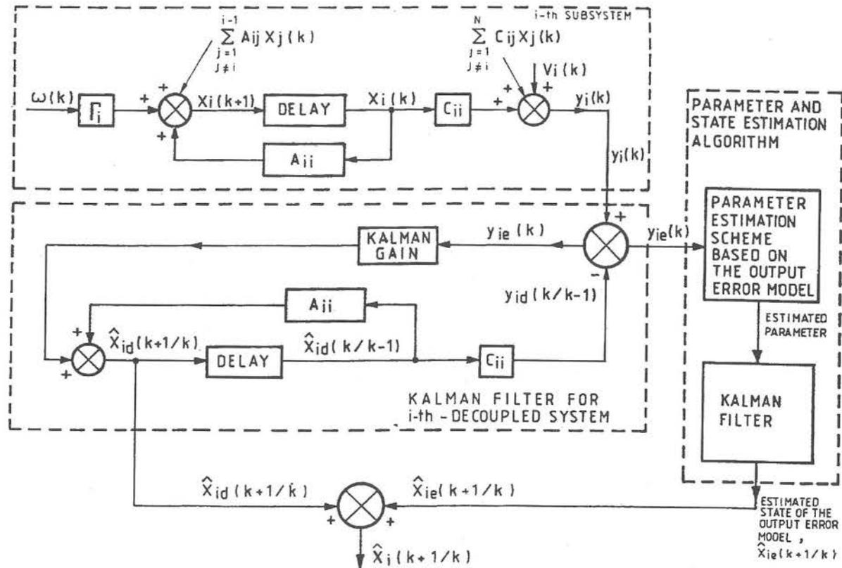
FIG. 1 SCHEMATIC DIAGRAM FOR DECENTRALIZED STATE ESTIMATION FOR THE  $i$ -th SYSTEM
